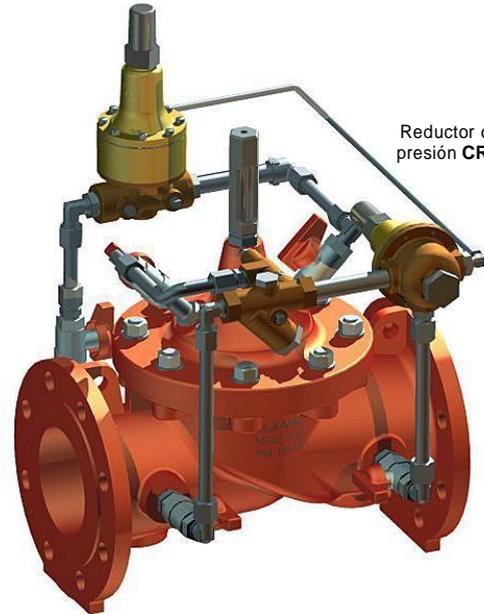
La SERIE CLA-VAL 90 reduce la presión aguas arriba a una presión aguas abajo inferior y constante sin incidencia de las fluctuaciones de caudal y/o de presión aguas arriba.
