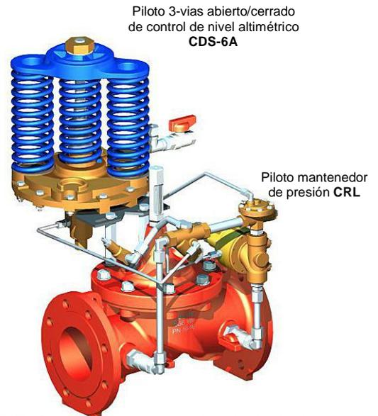
La SERIE CLA-VAL 210 controla el nivel alto de un depósito por medida hidrostática de su altura, sin recurrir a un piloto de flotador instalado en el interior del depósito.
